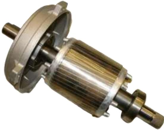
El rotor es la parte móvil que se sitúa en el interior del estator. En el eje se inserta un núcleo magnético ranurado de acero al silicio, en cuyas ranuras se colocan unas barras de cobre o aluminio (que realizan la función de conductores) en una disposición que se conoce como “jaula de ardilla”. Esto se debe a que las barras están unidas en cortocircuito por dos anillos, en la parte superior e inferior, confiriéndole una forma de jaula.
