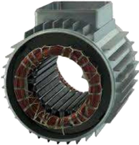
El estator es la parte fija y opera como la base del motor. Esta parte está constituida por una carcasa en la que se fijan una corona de chapas de hierro al silicio o acero al silicio, en las que están presentes unas ranuras. En estas ranuras es dónde se arrollan las bobinas.
