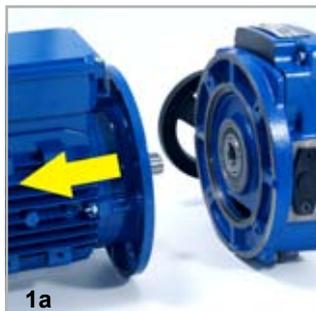
1a) Allentare le quattro viti che fissano il motore al variatore e sfilare il motore elettrico
