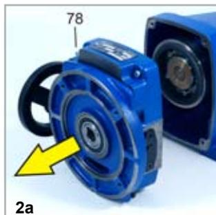
2a) Rimuovere le 4 viti di fissaggio 78 e smontare il coperchio del variatore
